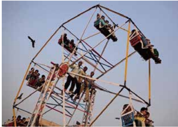
回転の動力を人力で行う例（インドの観覧車）
